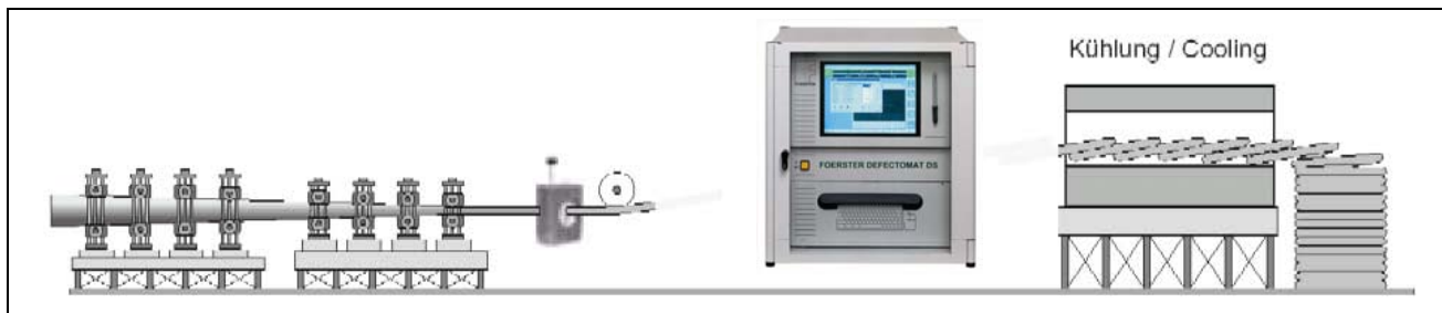
In-line контроль горячей катанки. Катушка перед холодильником
