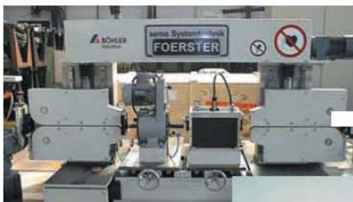
Компактная секция контроля с ленточным механизмом подачи позволяет контроль полированных прутков из нержавеющей стали Ø 2-20 мм с высокой чувствительностью на скорости до 2 м/с.
