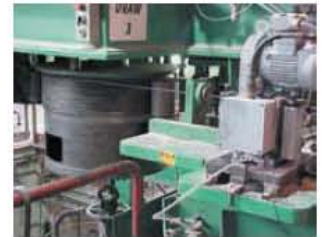
Контроль стальной проволоки непосредственно рядом с волочильным барабаном вращающейся головкой установки ЦИРКОГРАФ®
