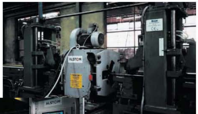
Точное и с низкой вибрацией направление материала обеспечивает надежные и воспроизводимые результаты при контроле стальных прутков с блестящей поверхностью с помощью ЦИРКОГРАФ® + Ro 65
