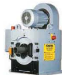
Специальной формы направляющие для Ro65 служат для проводки концов проволоки, особенно больших диаметров
