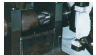
Специальной формы направляющие для Ro65 служат для проводки концов проволоки, особенно больших диаметров
