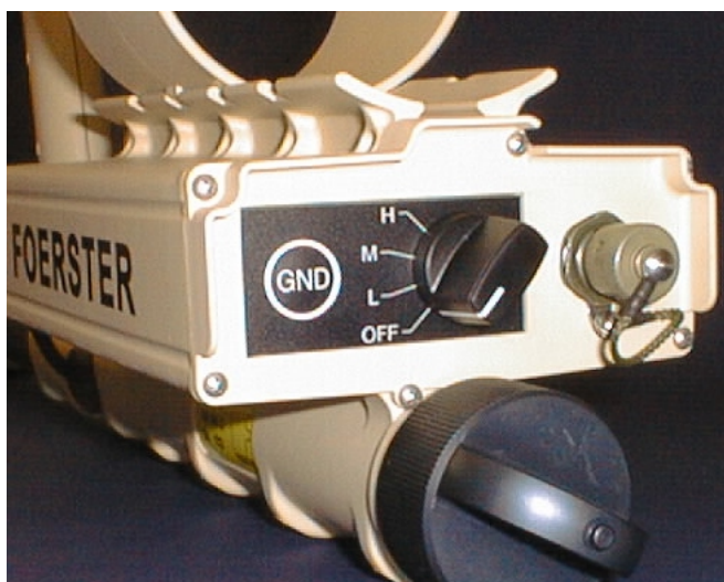
Рис. 2 MINEX 2FD с датчиком, повернутым на 180 ° и закрепленным снизу, для работы в положении "лежа"
