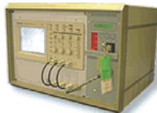
Рис.4 FOERSTER СИСТЕМА КОНТРОЛЯ STATOGRAPH ECM с цифровым осциллографом
